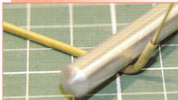
Fabricage van de uitlaat met messing pijp
